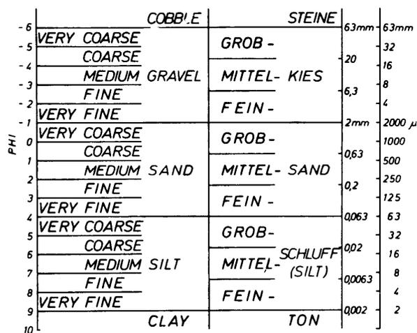
Abb. 4-18. Korngrößenbenennung. Links die Skala nach WENTWORTH (1922) und DOEGLAS (1968), rechts diejenige nach DIN 4022.
